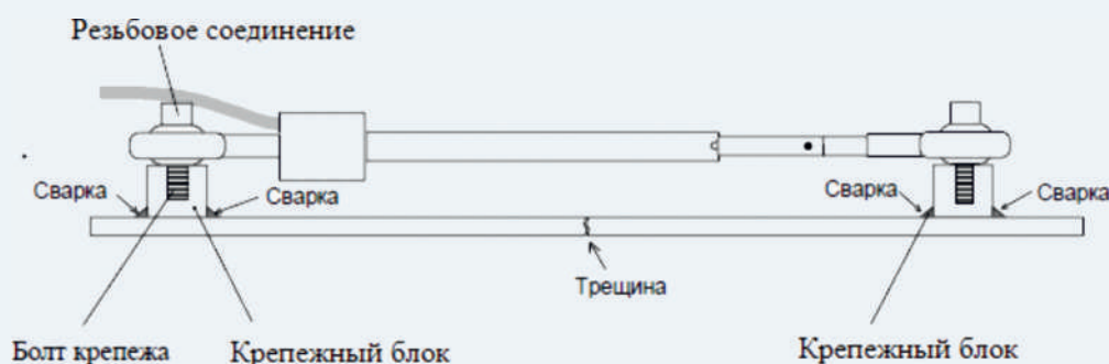
СХЕМА МОНТАЖА ISSO-CR
