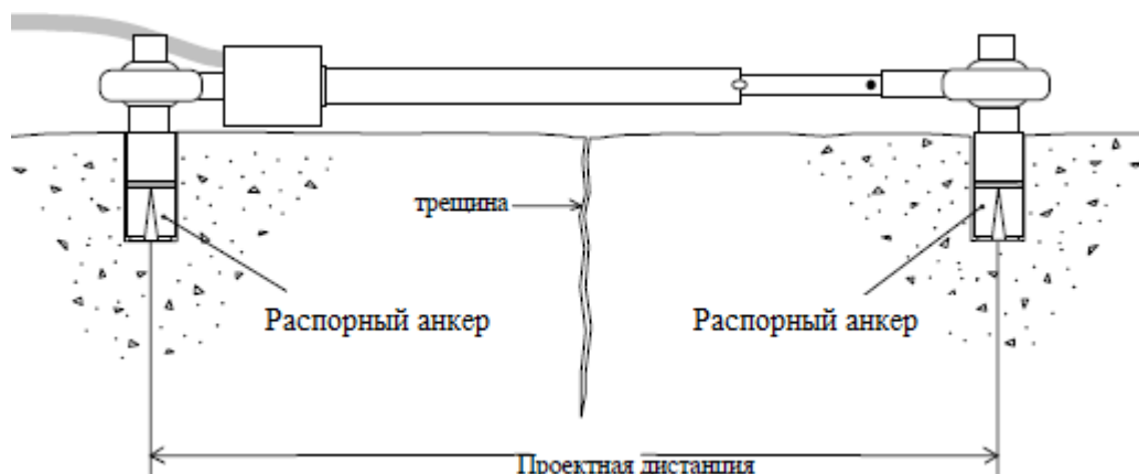
Рис. 2.3 Установка датчика на распорный анкер
