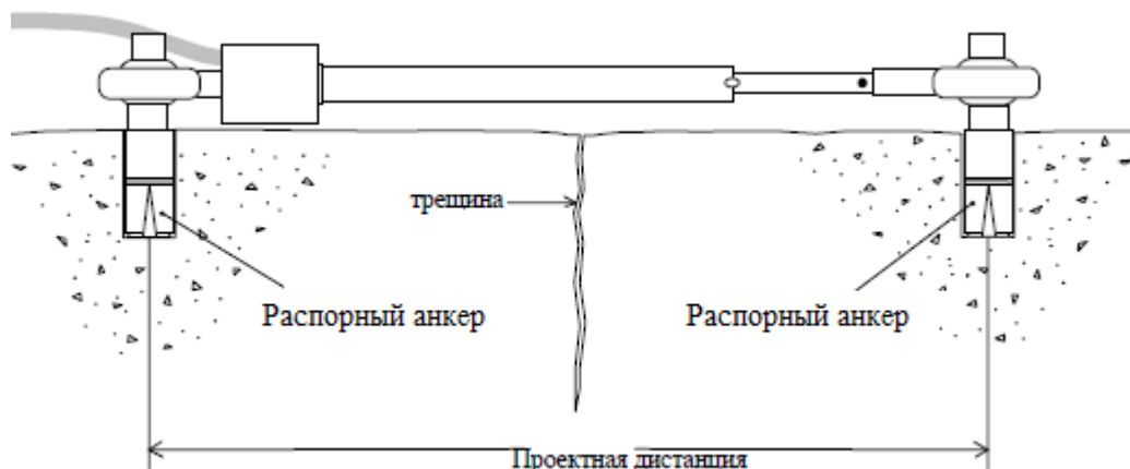
Рис. 2.3 Установка датчика на распорный анкер
