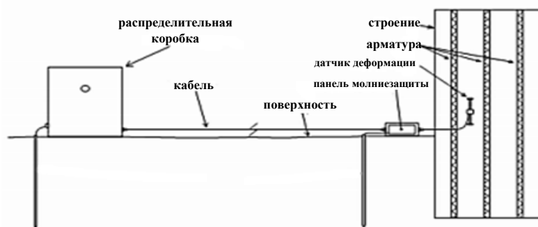
Рис. 7 - Рекомендуемая конструкция молниезащиты
