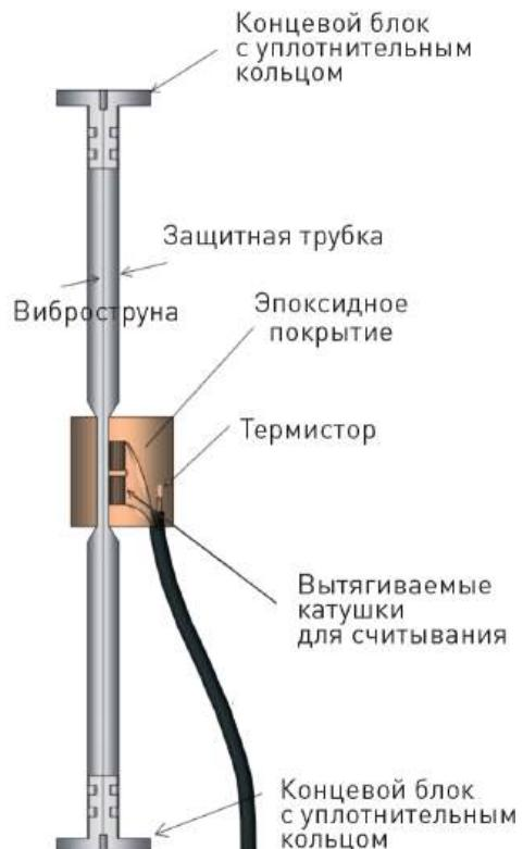
СХЕМА ДАТЧИКА SG4
