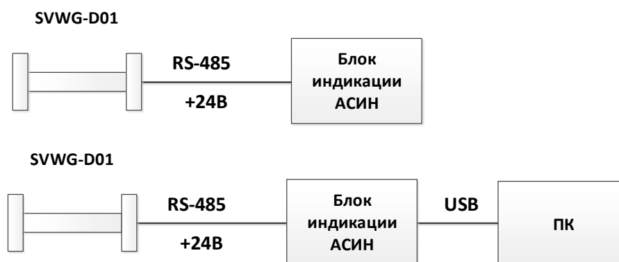
Рисунок 3 – Схема подключения датчика деформации к блоку индикации АСИН
