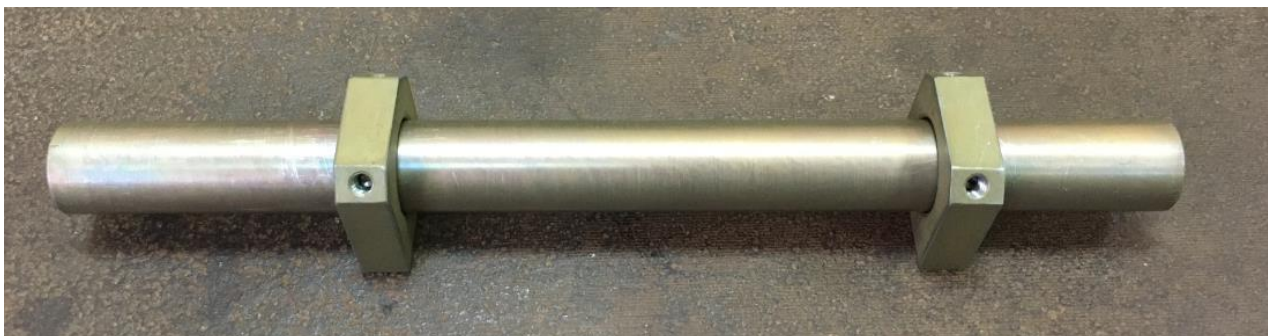
Рис.2 – Крепления анкеров на установочный шаблон.
