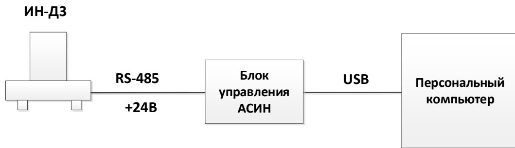
Рис. 5. Схема подключения измерителя к Блоку управления АСИН
