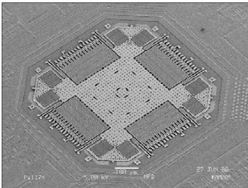
Рисунок 3. Фотография MEMS-преобразователя
