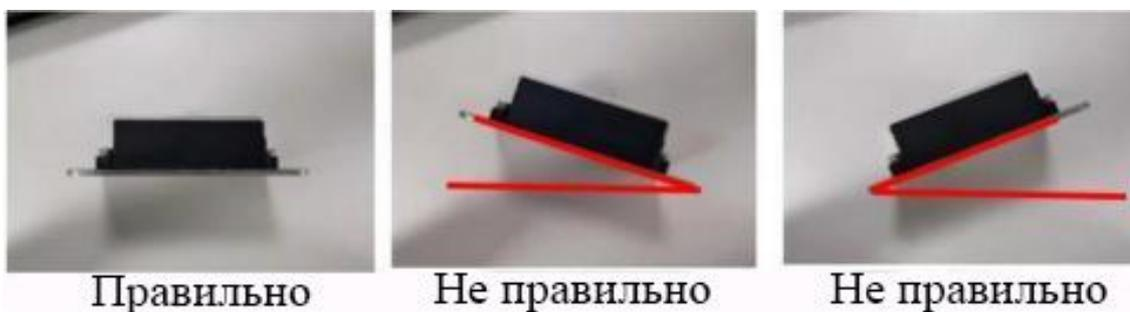
Рисунок 6. Установка датчика ISSO-TILTG
