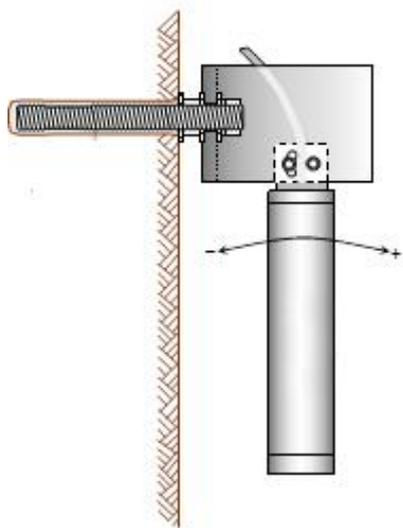
Рисунок 7. Установка датчика ISSO-TILT1
