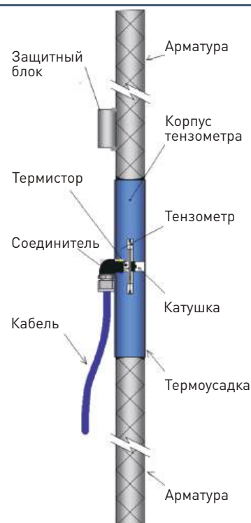
СХЕМА ДАТЧИКА ISSO-SG5
