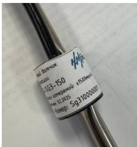
Рисунок 7 – Место нанесения маркировочной этикетки на примере датчика модификации ISSO-SG3-150
