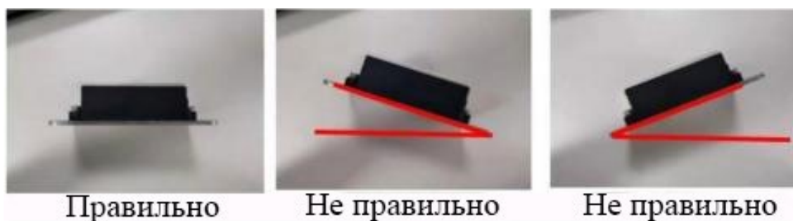
Рисунок 6. Установка датчика ISSO TILTG
