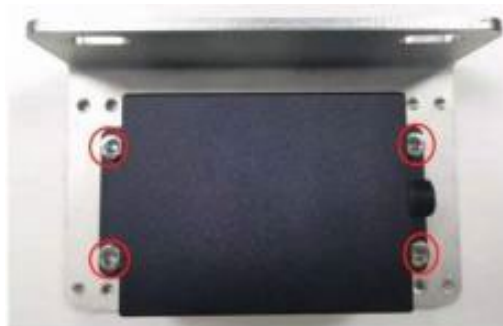
Рисунок 5. Крепление датчика ISSO TILTG к кронштейну
